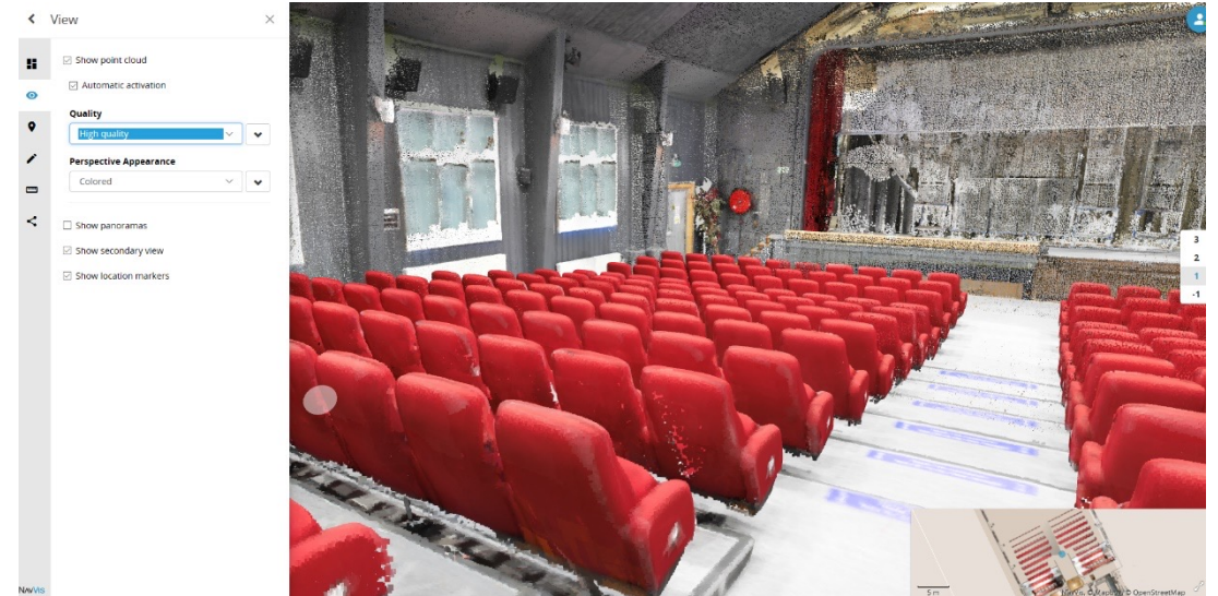
Punktsky fra 3D-skanning av kinosal på Setertun – stor nøyaktighet, men relativt høy pris ved bruk av innleide firma.
